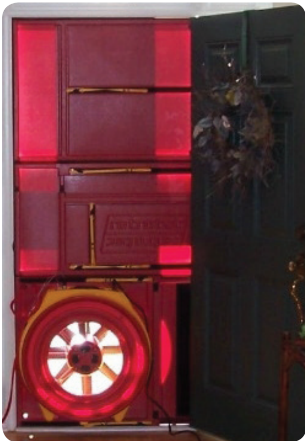
Blower Door Test
